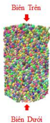
Hình 5.7: Điều kiện biên của thí nghiệm kéo, nén
