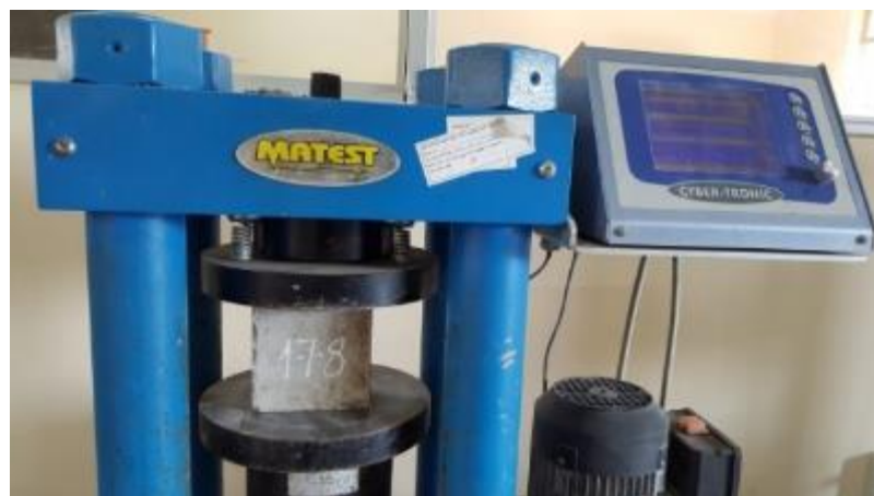
Hình 3.2: Thí nghiệm cường độ chịu nén
