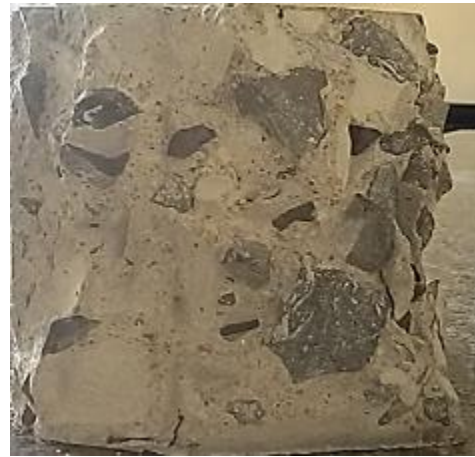
(b) Các vết nứt lan truyền theo biên các hạt cốt liệu trong bê tông đối chứng
