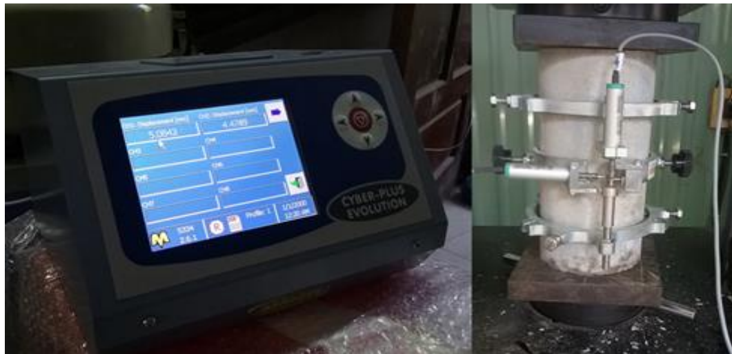
Hình 3.5: Thí nghiệm xác định module đàn hồi và hệ số poisson
