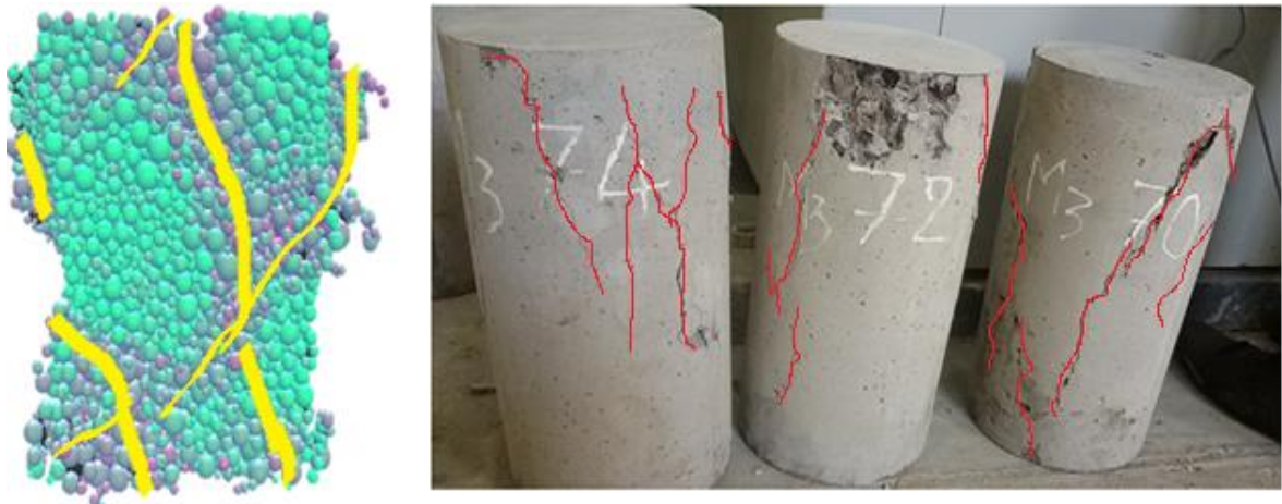
Hình 5.11: Quan sát vết nứt trên mẫu thí nghiệm số và mẫu thí nghiệm thực nghiệm
