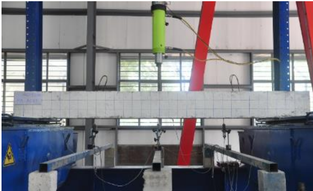
Hình 4.4: Thí nghiệm uốn 3 điểm với dầm BTCTXT
