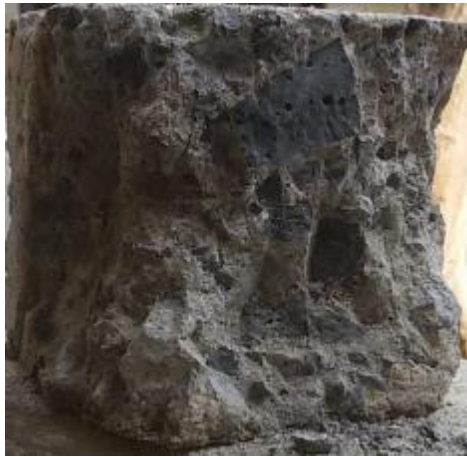
(a) Vết nứt cắt ngang hạt cốt liệu lớn trong bê tông xi thép
